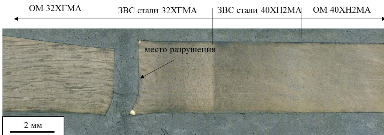
Рисунок 5.9 – Микроструктура разрушенных образцов сварных соединений сталей 32ХГМА-40ХН2МА после испытаний на многоцикловую усталость при изгибе с вращением. Отпуск 550 °С, 1 час: а) разрушение в зоне OM стали 32ХГМА; б) разрушение в ЗТМВ стали 32ХГМА
