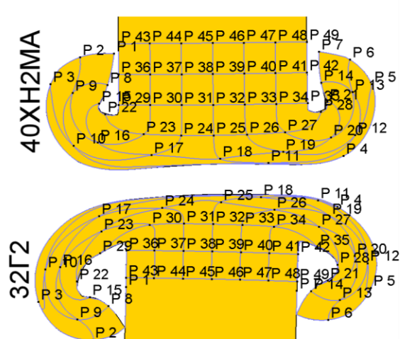
Рисунок 2.21 – Движение приконтактных объемов материала на различных этапах РСТ труб из сталей 32Г2-40XH2MA
