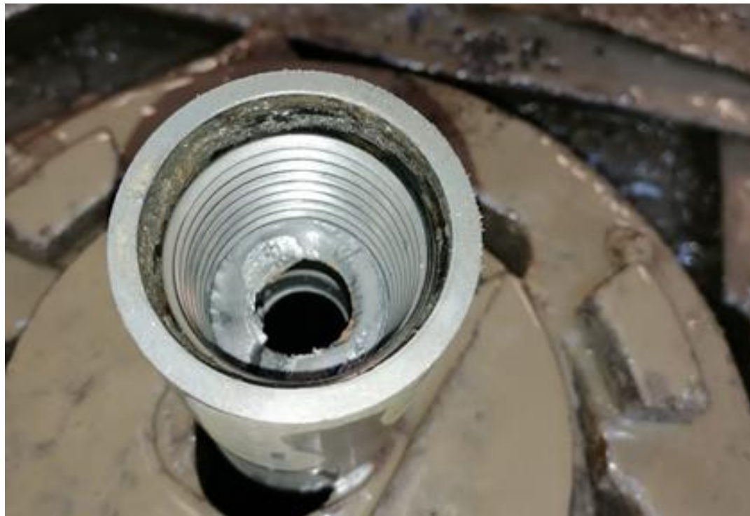
Рисунок 7.2 – Усталостное разрушение бурильной трубы ТБСУ Ø63,5×4,5 группы прочности Л после бурения в экстремальных условиях
