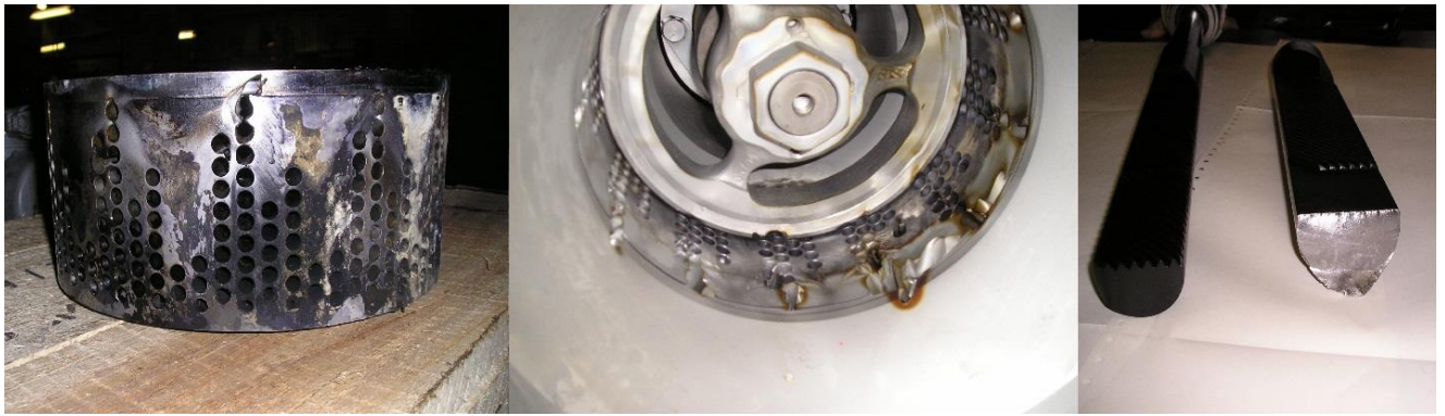
Рисунок 1.12 – Выход из строя механической части клапана
