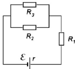
4. В изображенной на рисунке 1 схеме  $R_1=5$  Ом,  $R_2=2$  Ом,  $R_3=3$  Ом, э.д.с. источника  $E=3$  В, его внутреннее сопротивление  $r=1$  Ом. Найти силы токов, протекающих через сопротивления  $R_1$ ,  $R_2$  и  $R_3$ .
