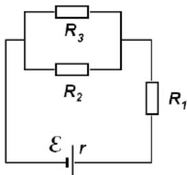
4. В изображенной на рисунке 1 схеме  $R_1=4$  Ом,  $R_2=2$  Ом,  $R_3=4$  Ом, э.д.с. источника  $E=2$  В, его внутреннее сопротивление  $r=4$  Ом. Найти силы токов, протекающих через сопротивления  $R_1$ ,  $R_2$  и  $R_3$ .
