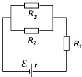
4. В изображенной на рисунке 1 схеме  $R_1=3$  Ом,  $R_2=2$  Ом,  $R_3=1$  Ом, э.д.с. источника  $E=1$  В, его внутреннее сопротивление  $r=2$  Ом. Найти силы токов, протекающих через сопротивления  $R_1$ ,  $R_2$  и  $R_3$ .
