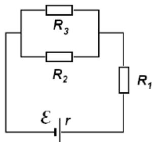
4. В изображенной на рисунке 1 схеме  $R_1=2$  Ом,  $R_2=2$  Ом,  $R_3=1$  Ом, э.д.с. источника  $E=2$  В, его внутреннее сопротивление  $r=1,5$  Ом. Найти силы токов, протекающих через сопротивления  $R_1$ ,  $R_2$  и  $R_3$ .
